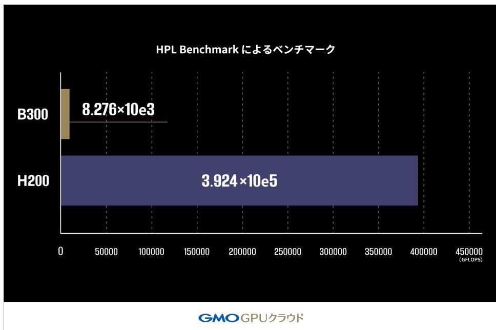
本ベンチマークでは HPL Benchmark<sup>(※10)</sup>を用いて「B300 GPU」搭載機材および「H200 GPU」搭載機材の LINPACK 性能<sup>(※11)</sup>を比較しました。HPL Benchmark では浮動小数点演算性能を測定し、1 秒間に実行できる演算回数を GFLOPS (10 億回の浮動小数点演算/秒)という単位で算出し、ベンチマークのスコアとします。この値が高いほど高性能であることを示します。
