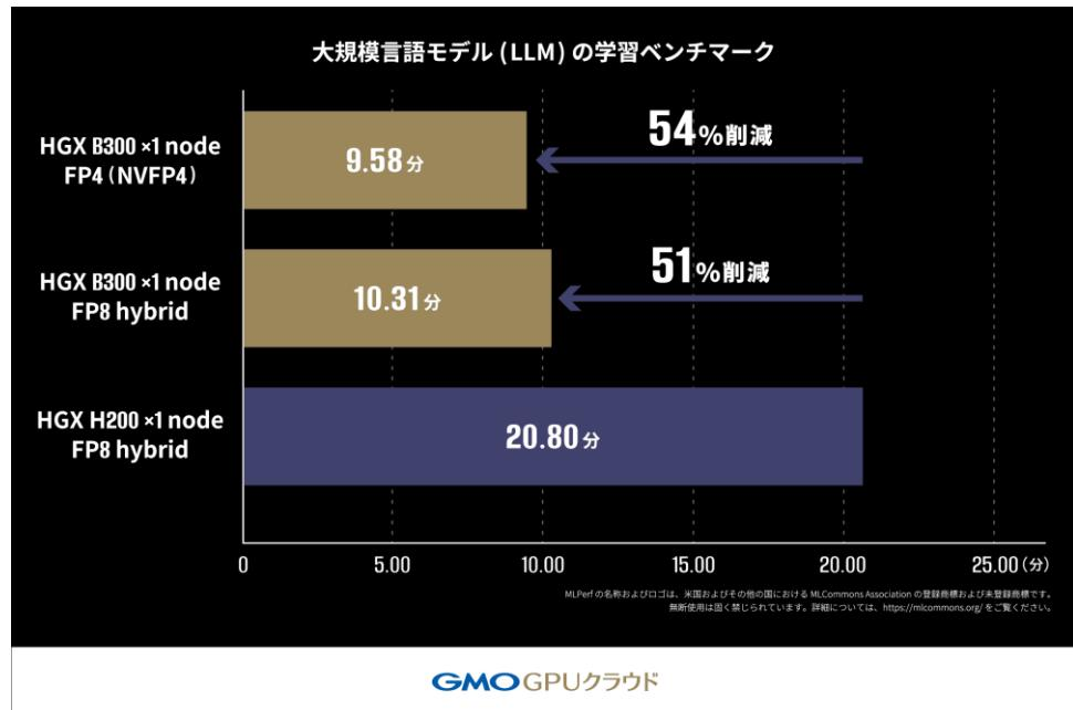
本ベンチマークでは、MLPerf® Training v5.1<sup>(※1)</sup> が規定している Closed Division のルールに従い、Llama2 70B モデルを用いて「B300 GPU」および「H200 GPU」上の LoRA ファインチューニング<sup>(※2)</sup>にかかる学習時間を測定しました<sup>(※3)</sup>。
